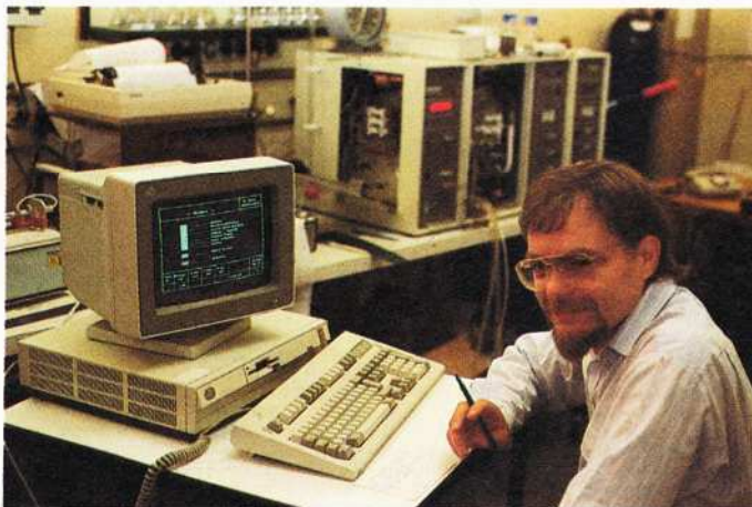
Mit einem IBM-AT und einem Gas-Chromatographen untersucht Dr. Artur Schulze von der Ruhr-Universität Abwasser und Klärschlämme auf organische Inhaltsstoffe.
